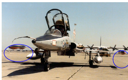
รูปที่ 5 - 8 F – 5 B ติดถังน้ำมันปลายปีกเพื่อลด tip wing vortex
