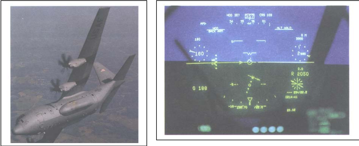
รูปที่ 4 C-130J สังกัด ทอ.สหรัฐ ฯ และ HUD แสดงข้อมูลการบิน
