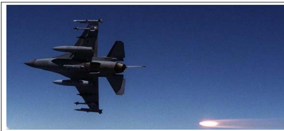
รูปที่ 4 USAF F-16 C ปล่อย flare ขณะตั้งเสถียรด้วยแรง 9g
