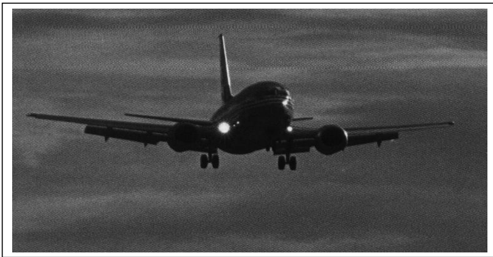
รูปที่ 6 - 2 Boeing 737-400 เปิด flaps และทางฐานล้อลง เพื่อร่อนลงสนาม
