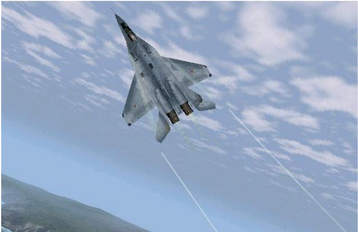
รูปที่ 5-11 Mig-29 M “Fulcrum” ดิ่งเสียวด้วยแรง +7 G สังเกตไอน้ำบริเวณโคนปีก และ Trailing Vortex บริเวณปลายปีกทั้งสองข้าง
