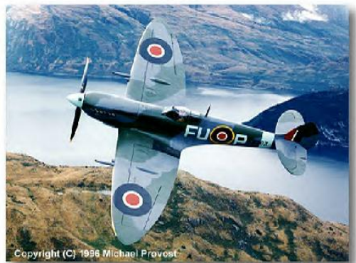
รูปที่ 5-5 เครื่องบิน Spitfire ทอ.อังกฤษ (WW II) มีปีกรูปวงรี ที่ให้การกระจายแรงยก ดีที่สุด และมีแรงต้านเหนี่ยวนำต่ำที่สุด
