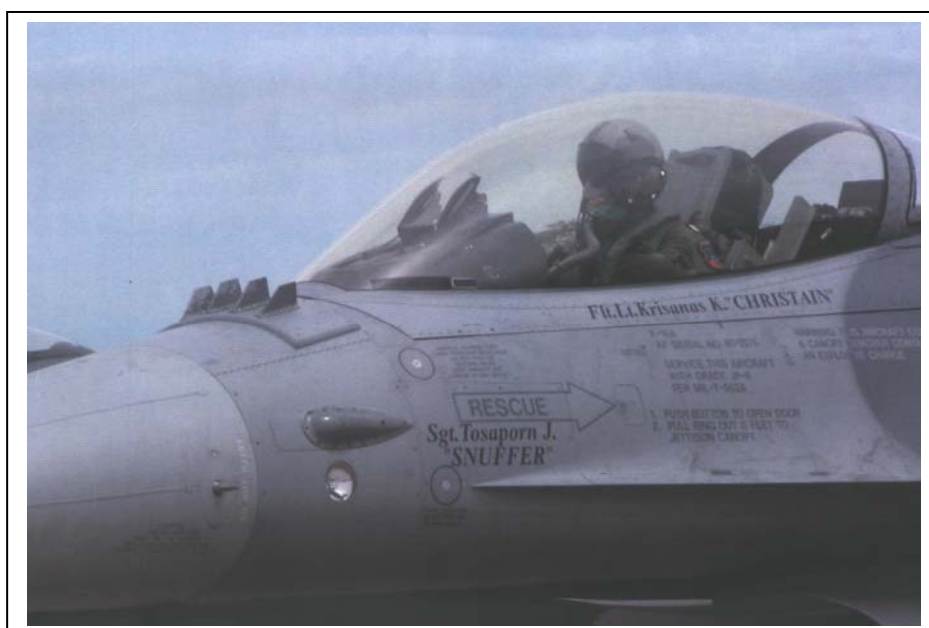
รูปที่ 9 “Bird Slicer” บริเวณส่วนหน้าฝาครอบห้องนักบิน เป็นส่วนหนึ่งของ AIFF (Advanced Identification Friend or Foe) ของ F-16 A/B ADF
