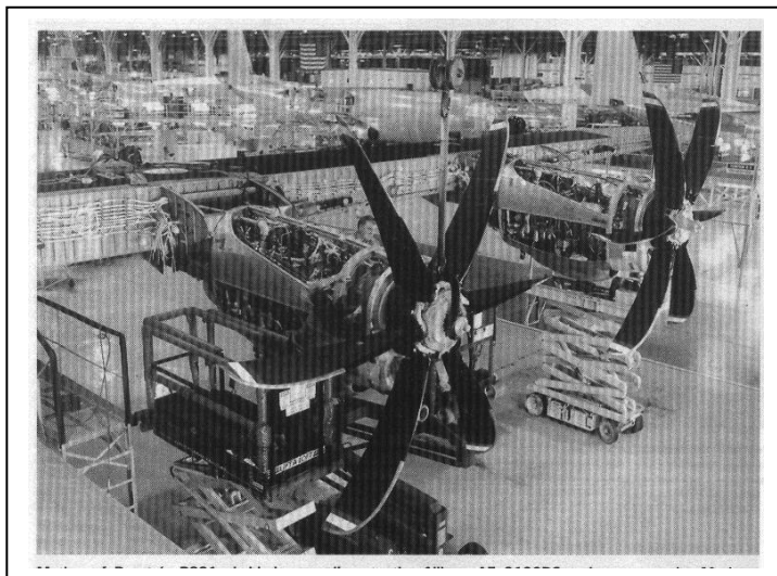
รูปที่ 5 เครื่องยนต์ Turboprop ของ Rolls Royce รุ่น AE2100D3 ให้กำลังขับเคลื่อนเครื่องละ 4,591 SHP
