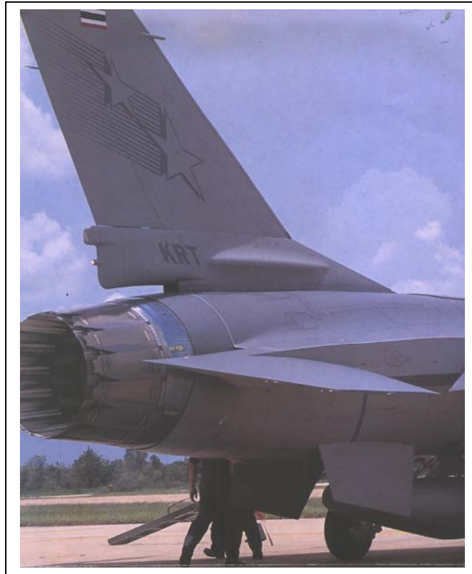
รูปที่ 10 ส่วนโป่งนูนบริเวณโคนแพนหางดิ่งของ F-16 A/B ADF บรรจุ Horizontal Stabilizer Accumulators ซึ่งวางซ้อนกัน แตกต่างกับ F-16 รุ่นอื่นๆ
